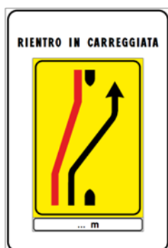
Figura 7.2.h: pannello composito di informazione, modificabile con lamierini da installarsi nella corsia in deviazione. Dimensioni 135 x 200 cm, su cavalletto.
