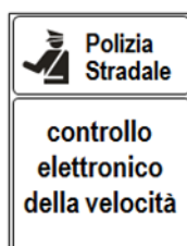
Figura 7.6.c: cartello di preavviso 90x135 cm da posizionare su cavalletto in anticipo rispetto alla posizione del box autovelox mobile.
