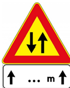
Figura 7.2.i: segnale Fig. II 387 Art. 31 del Reg. con cartello integrativo modello II 2 art. 83 di estensione da installarsi sulla corsia non deviata.
