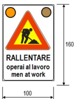
Figura 9.a: pannello composito di presegnalazione per lavori eseguiti lungo le corsie di decelerazione o sulle rampe di svincolo, dotato di 2 lampade a led ad alta efficienza diam. 200 mm. Superficie della targa non inferiore a 90 cm. Posizionamento sul margine destro in coincidenza dell'ago di inizio della decelerazione e ripetuto in condizioni di non perfetta visibilità
